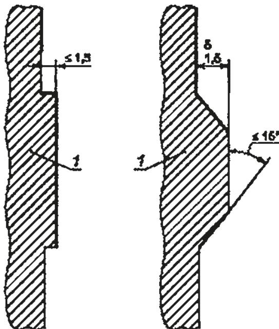
I — внутренняя поверхность двери шахты или стены ограждения шахты
