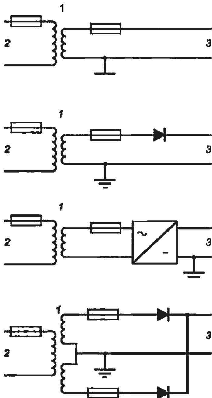
1 — разделительный трансформатор; 2 — первичный источник; 3 — схема управления
