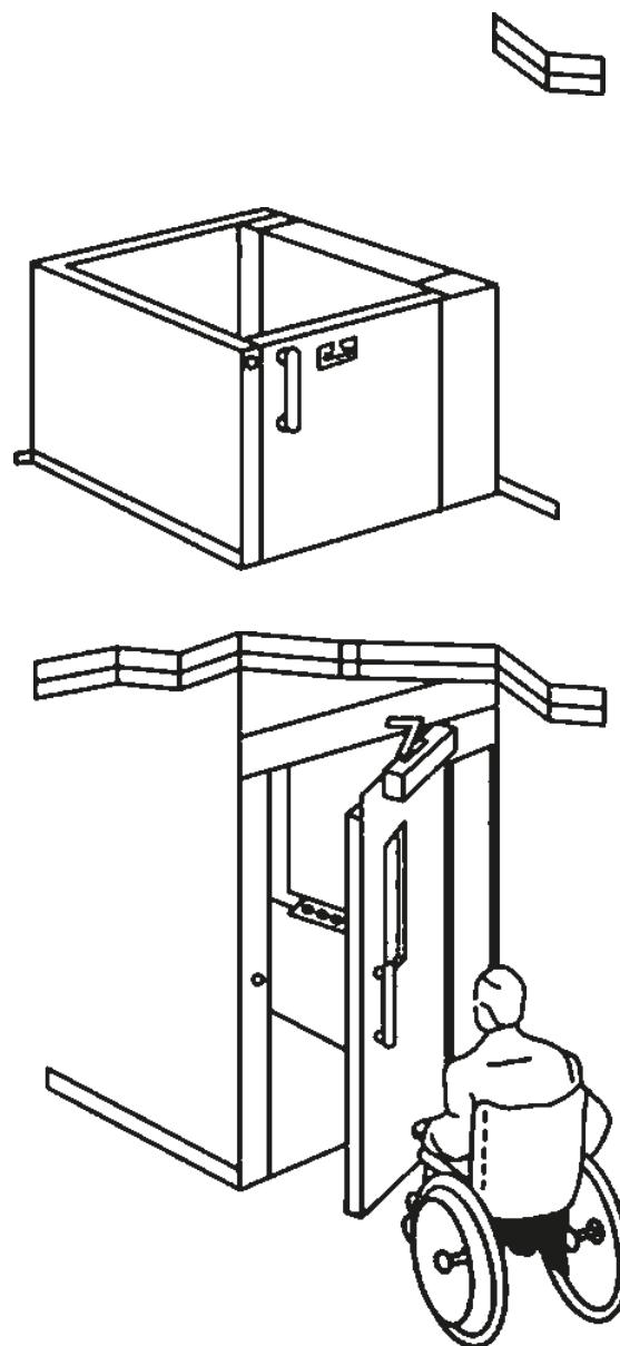
Рисунок 7 — Пример вертикальной платформы с огражденной шахтой
