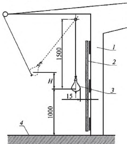
1 – рама; 2 – испытуемая стеклянная панель; 3 – маятник; 4 – уровень пола, относящийся к испытуемой стеклянной панели;  $H$  – высота падения
