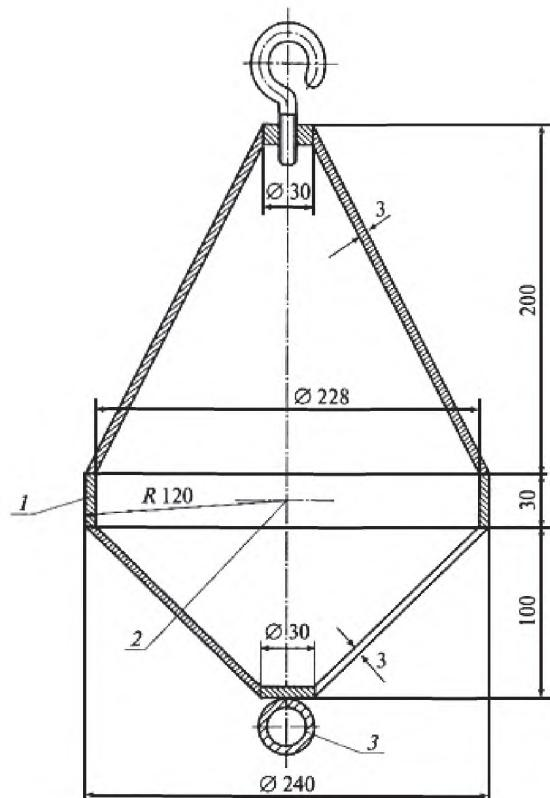
1 – ударное кольцо; 2 – базисная точка для измерения высоты падения; 3 – крепление пускающего приспособления
