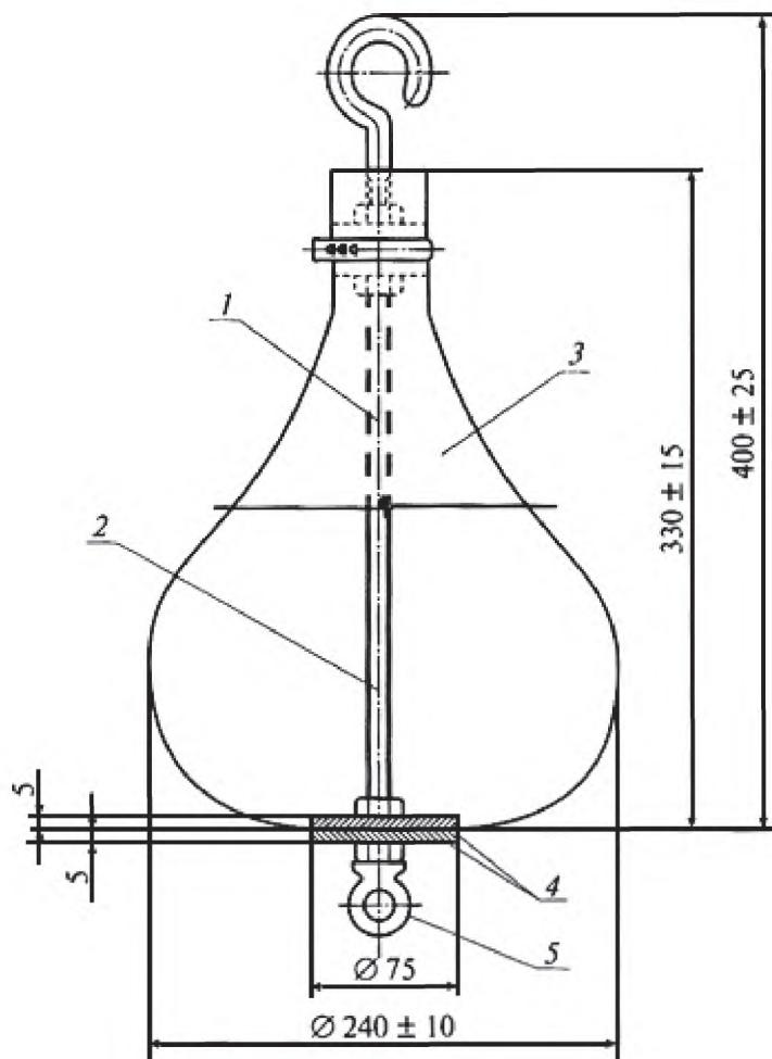
1 – стержень с нарезанной резьбой; 2 – базисная точка для измерения высоты падения в плоскости максимального диаметра; 3 – кожаный мешок; 4 – стальной диск; 5 – крепление пускающего приспособления
