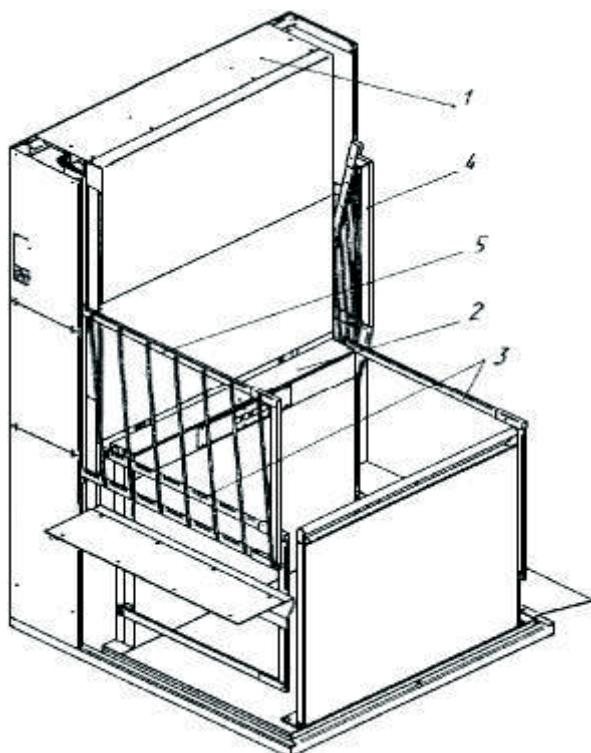
1 - подъемная платформа; 2 - грузонесущее устройство; 3 - автоматические реверсивные шлагбаумы, грузонесущего устройства; 4 - автоматические реверсивные шлагбаумы,
