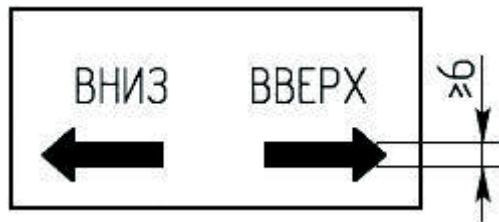
Рисунок 3 - Образец таблички с указанием направления перемещения
